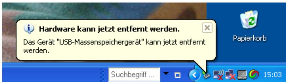
Jetzt kann der Stick sicher entfernt werden – was nur heisst, dass er sich überzeugt hat, dass kein Datentransfer mehr stattfindet.
